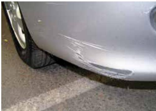
3. Scheuerstellen, Dellen und/oder Verformungen an einer Stoßstange in einem Bereich von mehr als 10 × 5 cm oder mit einer Länge von mehr als 30 mm.
