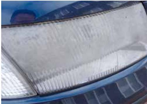
1. Steinschlag an den Scheinwerfern, Nebelscheinwerfern oder Blinkern, bei dem es nicht zu Glasbruch gekommen ist und die Funktionsfähigkeit der Leuchten nicht beeinträchtigt ist. Scheinwerfer müssen feuchtigkeitsdicht sein.
