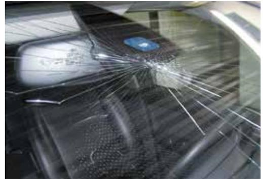
2. Risse über die gesamte Fläche der Windschutzscheibe mit Schäden an der äußeren Glasschicht. Schaden als Folge von Steinschlag, wodurch bei einer technischen Überprüfung nicht mehr die gesetzlichen Anforderungen an die Verkehrssicherheit erfüllt werden.
