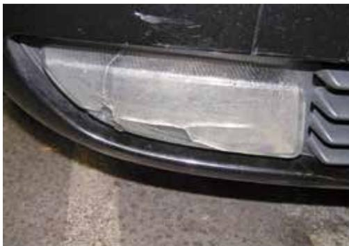
3. Steinschlag an Scheinwerfern, Nebelscheinwerfern oder Blinkern, der zum Bruch des Glases oder der durchsichtigen Abdeckung geführt hat. Die Einordnung dieser Mängel erfolgt ungeachtet des Umfangs des jeweiligen Schadens.
