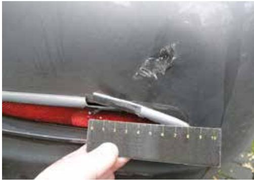
1. Stoßstange mit Rissen oder Kratzern, fehlende Abdeckung von Abschleppstange oder abnehmbarer Anhängerkupplung. Stoßstangen dürfen weder Löcher noch Risse aufweisen.
