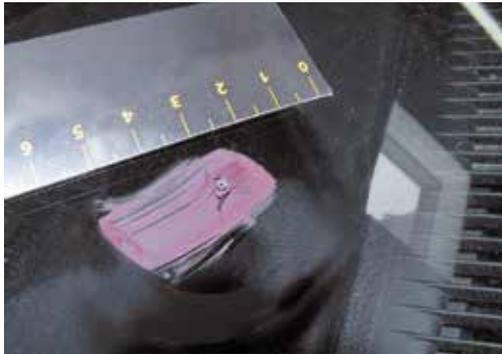
1. Riss in der Windschutzscheibe. Steinschlag, bei dem es - als Folge zahlreicher Risse oder durch die Stärke des Einschlags - zu Spiegel-effekten kommt oder der Beeinträchtigungen in Bezug auf die Sicht des Fahrers bei der Fahrt im Dunkeln oder bei Regen mit sich bringt.
